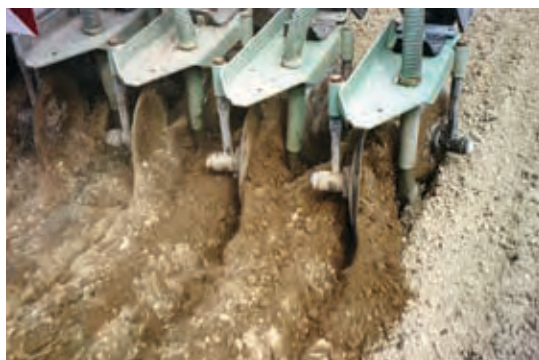
Správné zapravení: kejda vytéká z hadic aplikátoru do brázd, které se ihned zaklopí.
